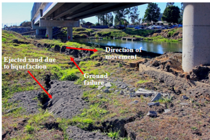
Εικόνα 3.15: Αστοχία εδάφους υπό μορφή καθίζησης, ύστερα από ρευστοποίηση τύπου ανακυκλιζόμενης κινητικότητας ( www.fhwa.dot.gov ).
