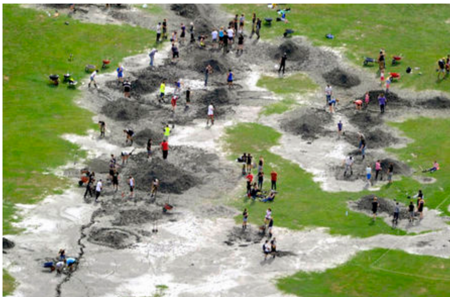
Εικόνα 3.11: Εμφάνιση φαινομένου ρευστοποίησης με δημιουργία κρατήρων άμμου στο Christchurch της Νέας Ζηλανδίας στις 28 Φεβρουαρίου 2011 ( www.blogs.aug.org ).
