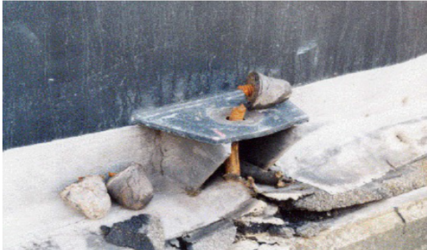
Εικόνα 2.18: Αστοχία στην αγκύρωση της δεξαμενής (ΕΜΠ, 2012).
